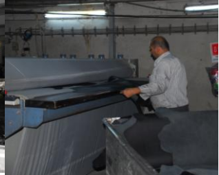
6. İskefe makinasında deriye yumuşaklık kazandırılması
