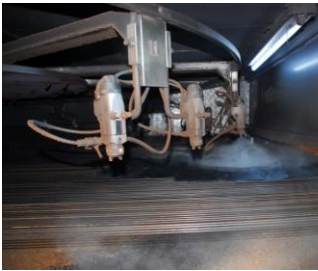
7. Hava tabancası ile boyama işlemi
