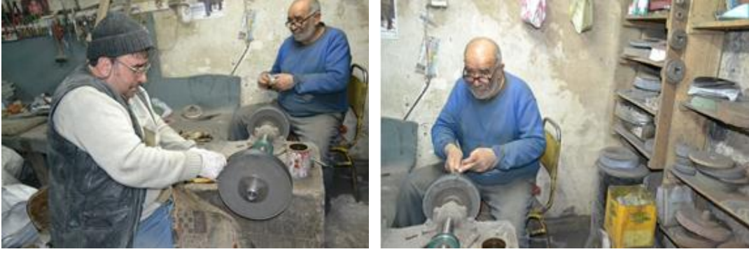
Resim 7: Bıçak bileme işlemi
