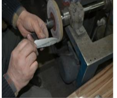
Resim 15: Namlunun zımpara taşıyla inceltilmesi
