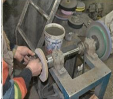
Resim 15: Namlunun zımpara taşıyla inceltilmesi
