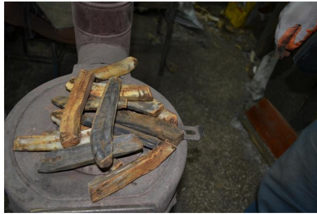
Resim 11: Sap için kesilmiş boynuzlar
