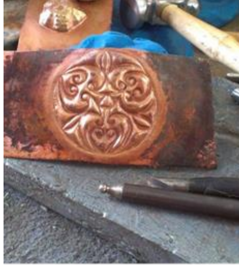
Resim 5. Bakır plaka üzerine pinçonla oluşturulmuş kabartma motif örneğ i, diğ er yüzü mine malzemesiyle doldurularak kabartma mine tekniğ i uygulanabilir (Bağlantı 6, 2023)
